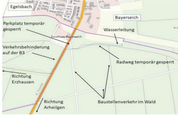
**Erzhausen/Egelsbach** (hus). Anfang Oktober wird eine Trinkwassertransportleitung an der B3 zwischen Wixhausen und Bayerseich saniert. Der zu sanierende Leitungsabschnitt verläuft ab dem Abzweig nach Erzhausen in Richtung Norden zunächst westlich der B3 und quert dann nach rund 50 Metern auf die östliche Seite. Kurz vor dem Forsthaus Bayerseich verschwenkt die Leitungstrasse in östlicher Richtung in den Wald bis zu einem Übergabebauwerk an der Ortsgrenze zu Egelsbach.
