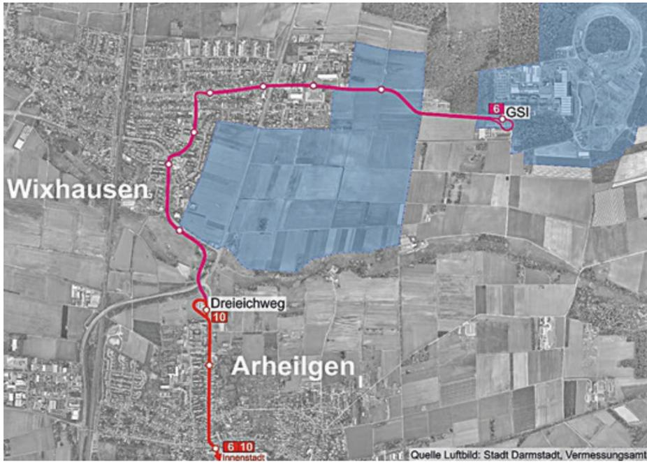
Die „Vorzugsvariante 6“ der „Machbarkeitsstudie Straßenbahn Wixhausen“ - ohne Verknüpfung mit der S-Bahn, aber mit langer Ausbaustrecke durch die Felder in den Ostwald zur GSI. Blau unterlegt: Das Gewerbe Entwicklungsgebiet Wixhausen Ost sowie die um den FAIR-Beschleuniger erweiterte GSI.
